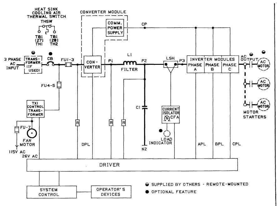
FIG. 2 AF-400 DRIVE SYSTEM BLOCK DIAGRAM
