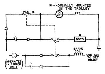
FIG. 33 POWER LIMIT SWITCH CIRCUIT
