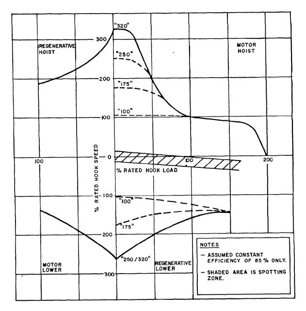
FIG. 3 TYPICAL SPEED-LOAD CURVES FOR MAXSPEED HOIST DRIVES
