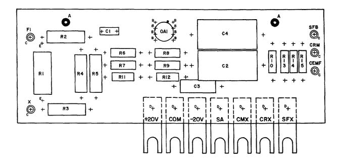
FIG. 10 SYNCHRONIZING CARD LAYOUT
