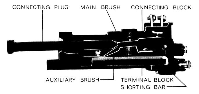
NOTE: AFTER ENGAGING AUXILIARY BRUSH CONNECTING PLUG TRAVELS  $\frac{1}{4}$  INCH BEFORE ENGAGING THE MAIN BRUSH ON THE TERMINAL BLOCK
