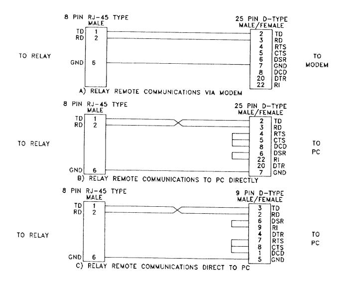
CABLES AVAILABLE UNDER GE PART NO. 0246A9866. SPECIFY CABLE TYPE AND CONNECTOR GENDER.
