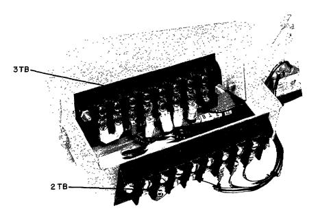
POWER CONVERSION MODULE REMOVED - 2TB HINGED DOWN POSITION
