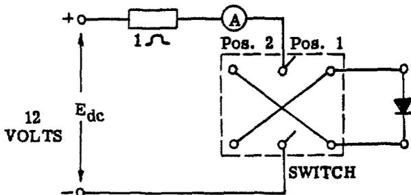
Figure 12. Rectifier Test Circuit
