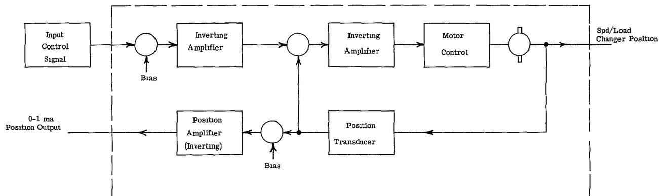
BLOCK DIAGRAM OF SIGNAL CONVERTER MODEL 3S7513TC108
