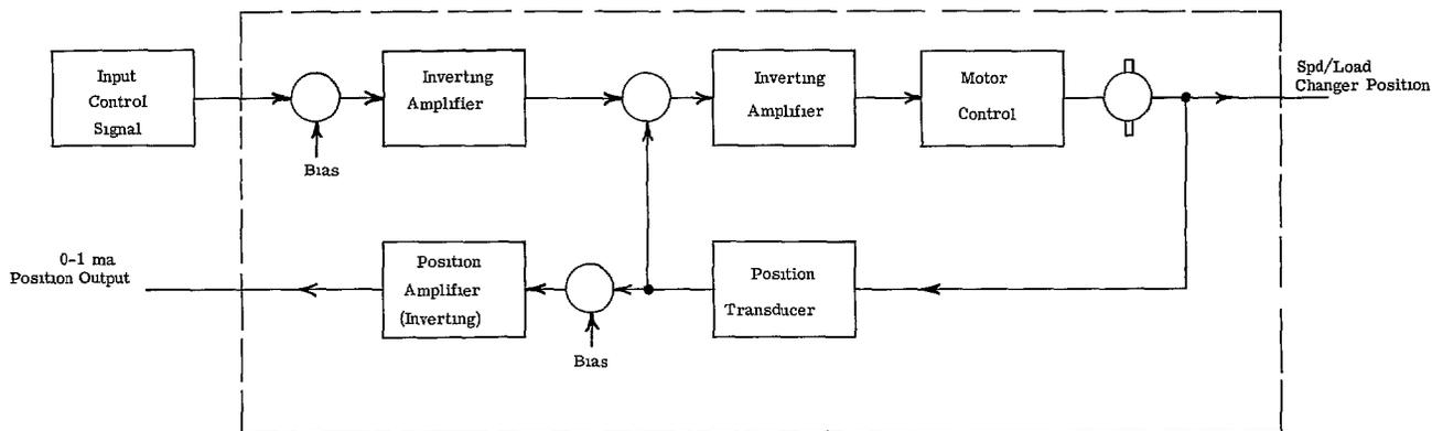
BLOCK DIAGRAM OF SIGNAL CONVERTER MODEL 3S7513TC108
