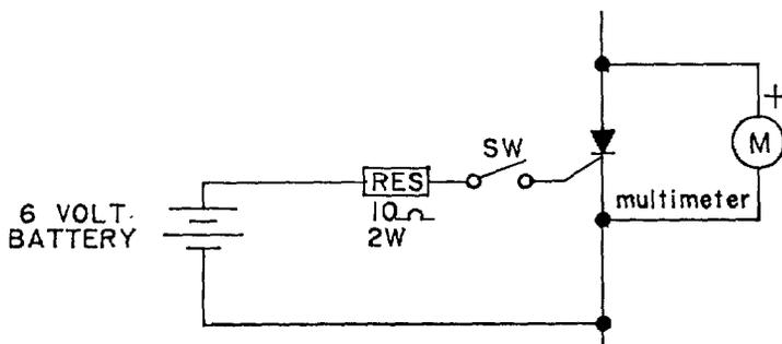
**FIG. 24 SCR TEST CIRCUIT**
