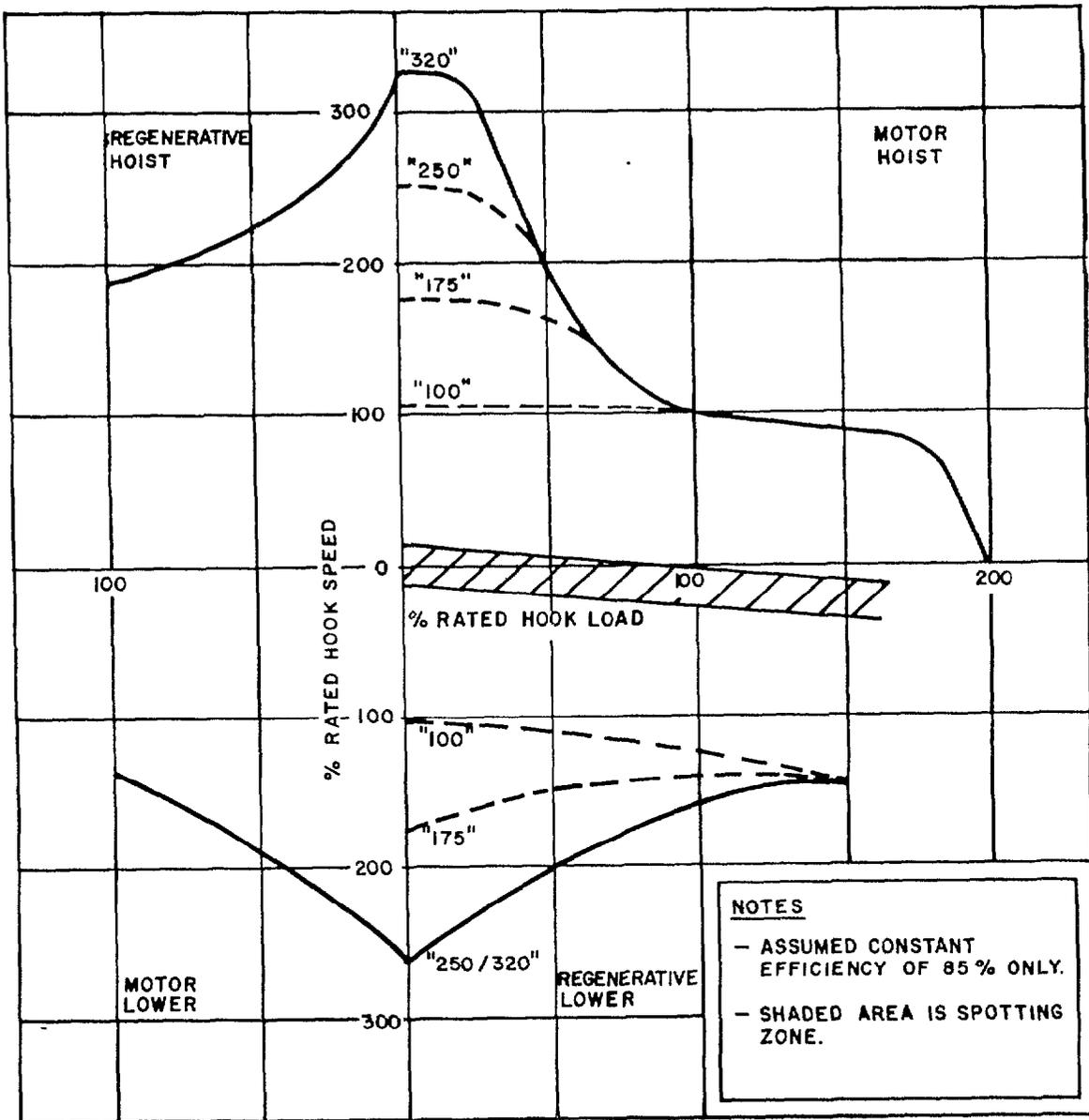
FIG. 3 TYPICAL SPEED—LOAD CURVES FOR MAXSPEED HOIST DRIVES
