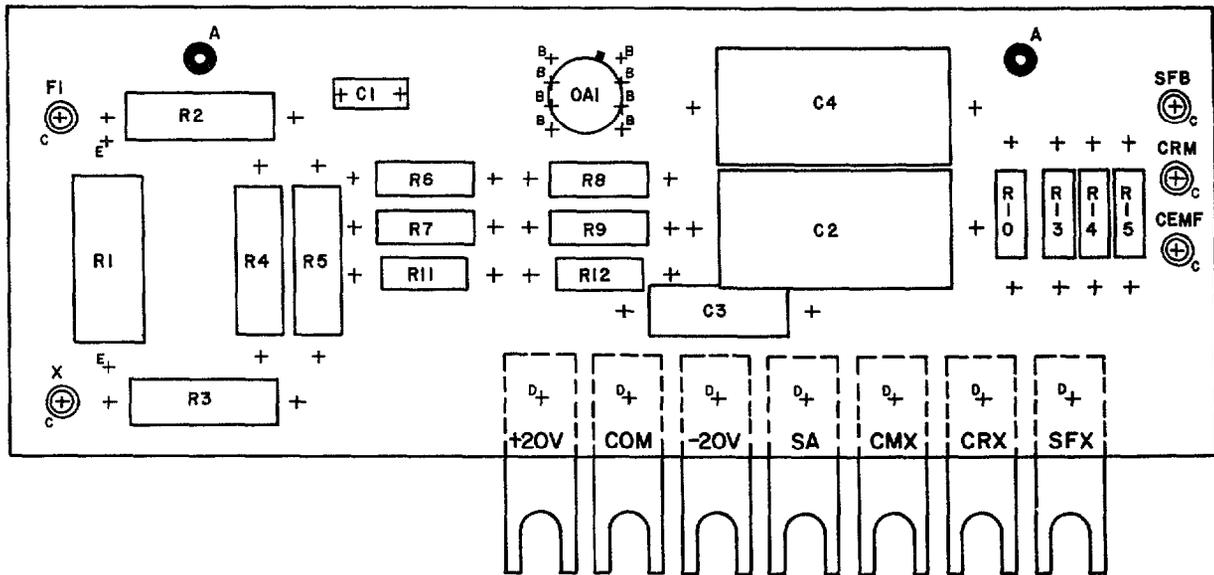
FIG. 10 SYNCHRONIZING CARD LAYOUT
