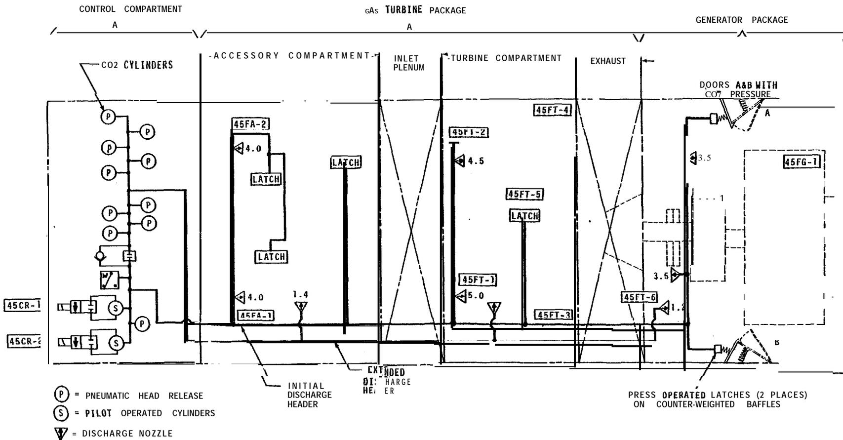
SCHMATIC DIAGRAM OF HIGH PRESSURE CO2 FIRE PROTECTION SYSTEM FOR PACKAGE POWER PLANTS.
