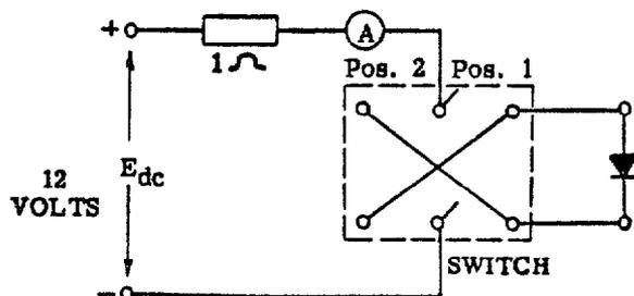
Figure 13. Rectifier Test Circuit
