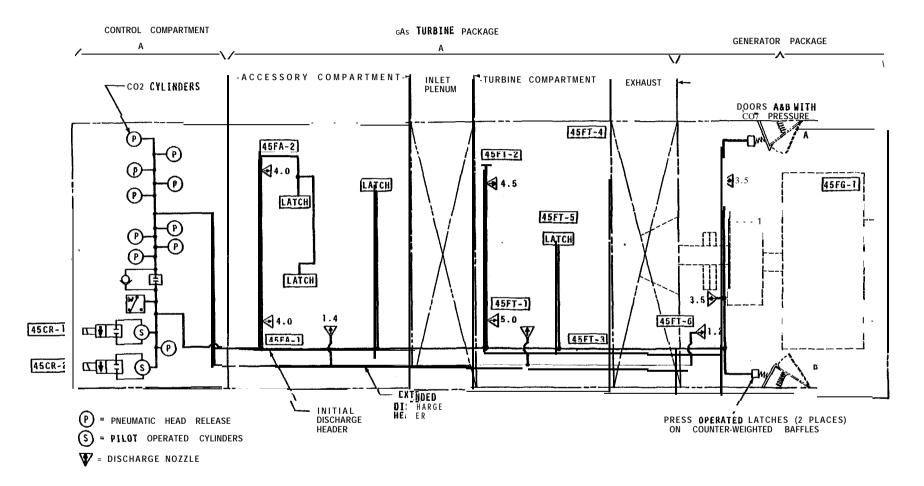
SCHEMATIC DIAGRAM OF HIGH PRESSURE CO2 FIRE PROTECTION SYSTEM FOR PACKAGE POWER PLANTS.
